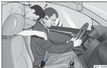
Bild 8 Passageraren i baksätet som inte använder säkerhetsbälte kastas framåt med en våldsam kraft och träffar föraren som använder säkerhetsbältet.
