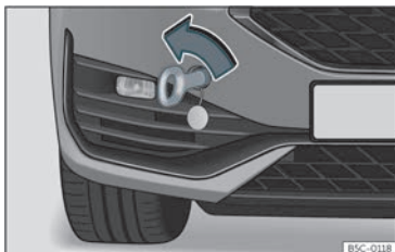
Bild 48 Höger sida på stötfångaren fram: fäste för bogserlinan i position.
