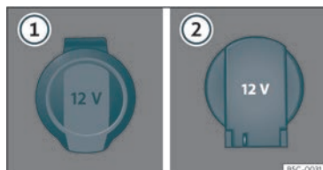
Bild 140 12-voltsuttag: ① i det främre armstödet, ② i bagageutrymmet.
