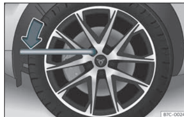
Bild 41 Hjulbyte: lossa hjulbultarna.
