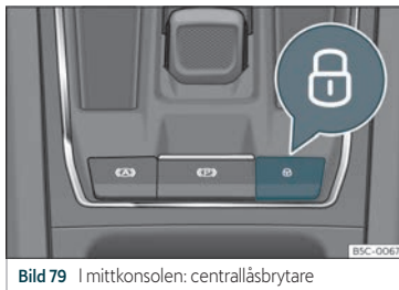
Bild 79 I mittkonsolen: centrallås brytare
