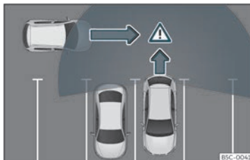
Bild 183 Schematisk framställning av assistenten för korsande trafik bakom bilen: övervakat område runt bilen när bilen kör ut ur en parkeringsplats.
