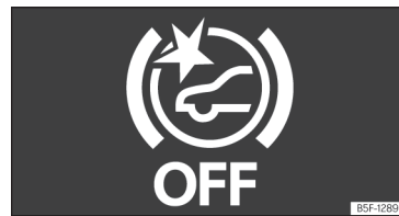
Bild 169 På instrumentpanelens display: Indikering om att Front Assist är avaktiverat.
