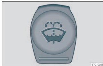
Bild 220 I motorrummet: lock till spolarvätskebehållaren.
