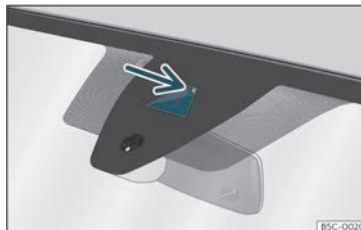
Bild 161 På vindrutan: Synfältet för Lane Assist-systemet.
