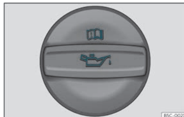
Bild 216 I motorrummet: Påfyllningslock för motorolja.
