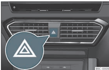
Bild 96 Instrumentpanel: knapp för varningsblin- kers
