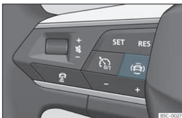
Bild 66 Multifunktionsrattens vänstra sida: knapp för förarstödsystem (beroende på version).
