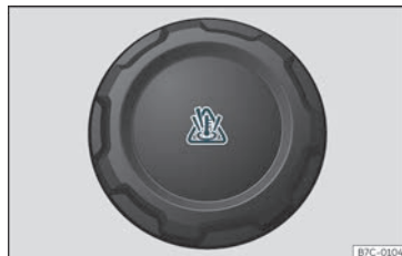
Bild 218 Motorrum: lock till expansionstanken.
