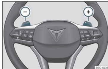
Bild 157 Ratt: reglage för automatisk växellåda
