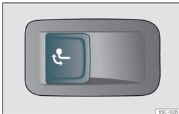
Bild 198 På bagagerummets vänstra sida: knapp för att låsa upp dragkrok.
