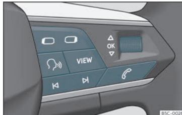
Bild 64 Multifunktionsrattens högra sida: Knappar för att använda kombiinstrumentets menyer och informationsdisplayer (beroende på version)
