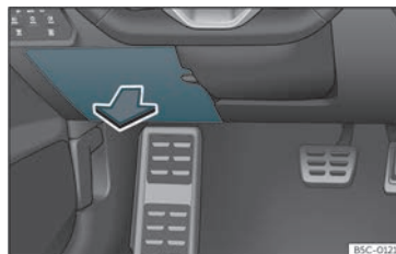
Bild 51 På instrumentbrädan på förarsidan: säkringsdosans lock.
