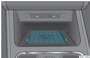
Bild 131 | Mittkonsolen: platta för anslutning av mobiltelefon.
