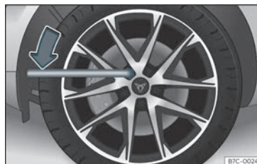
Bild 37 Hjulbyte: lossa hjulbultarna.
