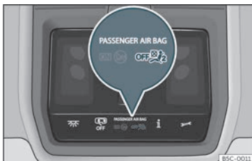
Bild 16 På takkonsolen: signallampa som visar om krockkudden på passagerarsidan fram är inaktiverad.
