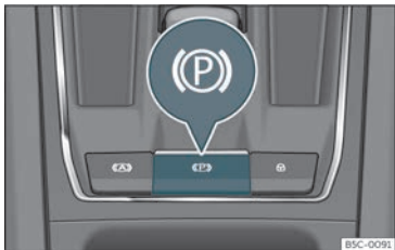
Bild 167 I den nedre delen av mittkonsolen: knapp för elektronisk parkeringsbroms
