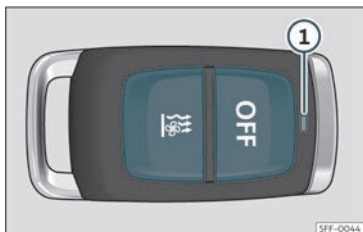
Bild 125 Parkeringsvärmare: radiostyrd fjärrkontroll.
