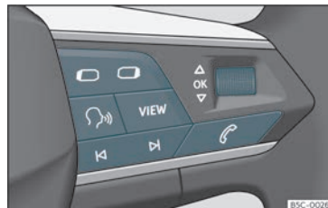
Bild 56 Multifunktionsrattens högra sida: Knappar för att använda kombiinstrumentets menyer och informationsdisplayer (beroende på version).
