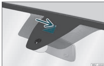
Bild 142 På vindrutan: synfältet för Lane Assist-systemet.
