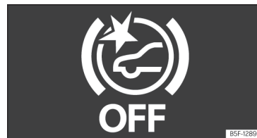
Bild 150 På instrumentpanelens display: Indikering om att Front Assist är inaktiverat.
