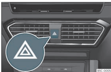
Bild 87 Instrumentpanel: knapp för varningsblinkers
