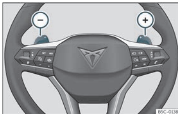
Bild 138 Ratt: reglage för automatisk växellåda
