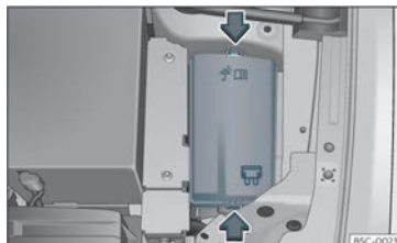
Bild 48 I motorrummet: säkringsdosans lock.
