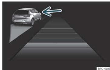
Bild 153 På instrumentpanelens display: ACC aktiv, fordon upptäckt i en ytterfil.
