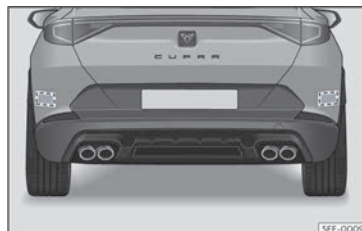
Bild 143 Vy över bilens bakre del: radarsensorområdet.
