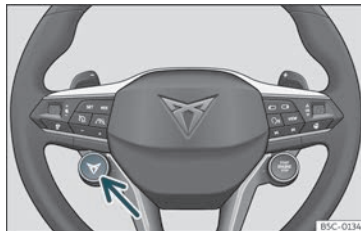
Bild 139 Multifunktionsratt*: knapp för att ändra körprofil.
