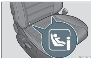
Bild 28 Främre passagerarsäte: ISOFIX-/iSize-monteringsringar.
