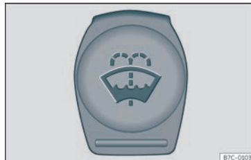
Bild 191 I motorrummet: lock till spolärvätskebehållaren.
