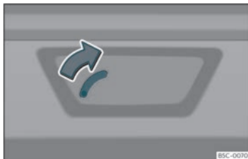
Bild 81 Detaljer kring bagageutrymmet: nödupplåsning
