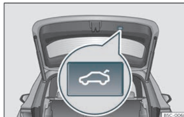
Bild 78 Baklucka: knapp för att stänga bakluckan.
