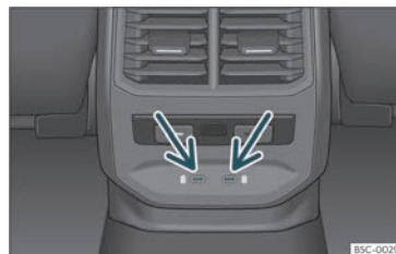
Bild 133 Bakre delen av mittkonsolen: USB-kontakter med laddningsfunktion.
