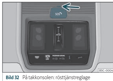
Bild 32 På takkonsolen: rösttjänstreglage
