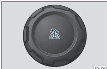
Bild 189 Motorrum: lock till expansionsstanken.
