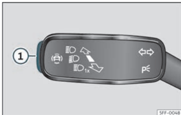
Bild 57 På spaken för blinkers och helljus: knapp för förarstödsystem (beroende på version).
