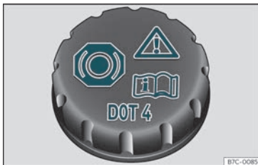
Bild 190 Motorrum: lock till bromsvätskebehållaren.
