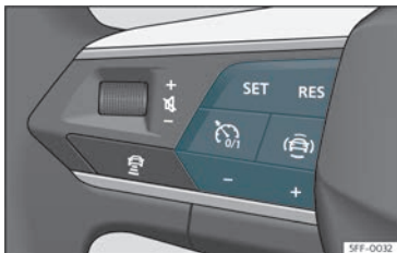
Bild 146 På multifunktionsratten: knappar för att reglera hastighetsbegränsaren.
