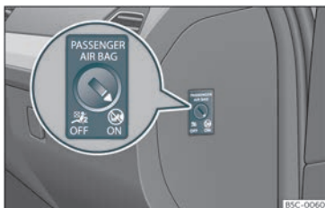
Bild 15 Brytare för aktivering och inaktivering av passagerarkrockkudden.
