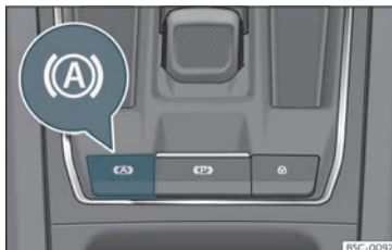
Bild 168 I den nedre delen av mittkonsolen: Auto Hold-funktionsknapp.
