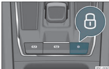
Bild 71 | Mittkonsolen: centrallås brytare
