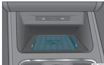
Bild 131 I mittkonsolen: platta för anslutning av mobiltelefon.
