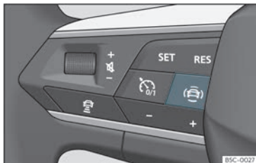
Bild 58 Multifunktionsrattens vänstra sida: knapp för förarstödsystem (beroende på version).
