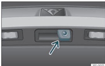
Bild 145 I handtaget på bakluckan: placering av backkameran.
