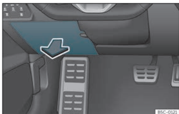
Bild 47 På instrumentbrädan på förarsidan: säkringsdosans lock.
