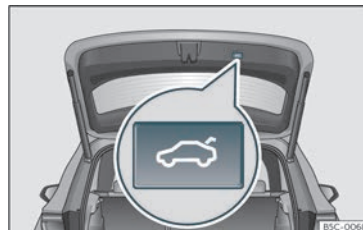
Bild 78 Baklucka: knapp för att stänga bakluckan.
