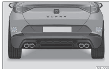
Bild 143 Vy över bilens bakre del.: radarsensorområden.
