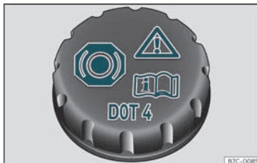
Bild 190 Motorrum: lock till bromsvätskebehållaren.
