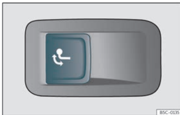
Bild 179 På bagagerummets vänstra sida: knapp för att låsa upp dragkrok.
