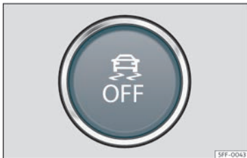
Bild 169 I den nedre delen av mittkonsolen: knapp för att slå på/av ESC
