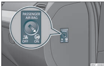
Bild 15 Brytare för aktivering och inaktivering av passagerarkrockkudden.
