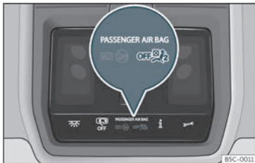
Bild 16 På tacksolen: signallampa som visar om krockkudden på passagerarsidan fram är inaktiverad.
