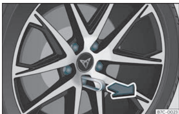
Bild 35 Hjul: hjulbultar med lock.
