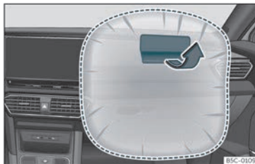
Bild 14 Passagerarkrockkudde fram monterad i instrumentpanelen.
