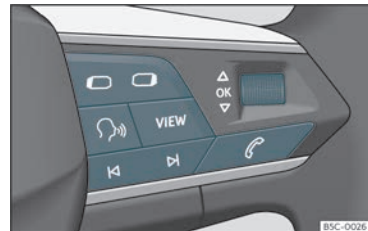
Bild 56 Multifunktionsrattens högra sida: knappar till menyerna och informationskärmarna på instrumentpanelen.
