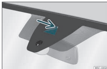
Bild 142 På vindrutan: synfältet för Lane Assist-systemet.
