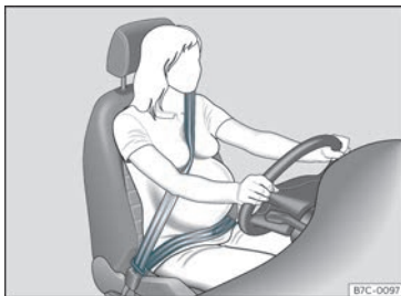
Bild 12 Positionering av säkerhetsbälte vid graviditet.
