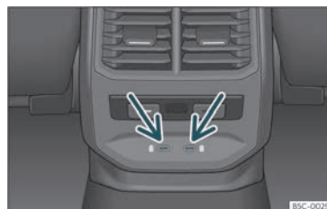
Bild 133 Bakre delen av mittkonsolen: USB-kontakter med laddningsfunktion.
