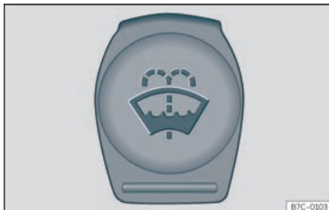
Bild 191 I motorrummet: lock till spolarvätskebehållaren.
