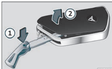
Bild 68 Bilnyckel: öppna batteriluckan.
