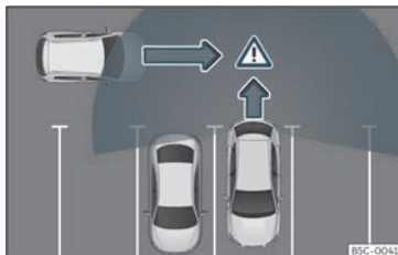
Bild 164 Schematisk framställning av assistenten för korsande trafik bakom bilen: övervakat område runt bilen när bilen kör ut ur en parkeringsplats.
