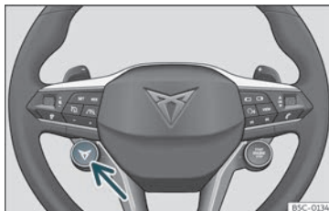
Bild 139 Multifunktionsratt*: knapp för att ändra körprofil.
