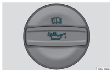
Bild 187 I motorrummet: Påfyllningslock för motorolja.
