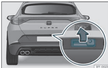
Bild 77 Baklucka: öppning från utsidan.
