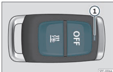
Bild 125 Parkeringsvärmare: radiostyrd fjärrkontroll.
