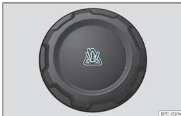
Bild 189 Motorrum: lock till expansionstanken.
