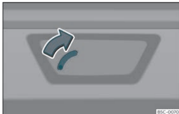
Bild 81 Detaljer kring bagageutrymmet: nödupplåsning
