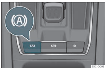
Fig. 173 I den nedre delen av mittkonsolen: Auto Hold-funktionsknapp.
