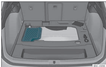
Fig. 211 Batteriets placering i bagageutrymmet
