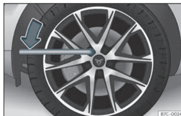
Fig. 37 Hjulbyte: lossa hjulbultarna.
