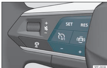
Fig. 152 På multifunktionsratten: knappar för att reglera hastighetsbegränsaren.
