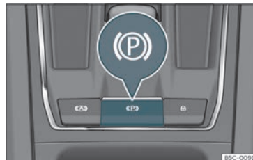
Fig. 172 | Den nedre delen av mittkonsolen: knapp för elektronisk parkeringsbroms
