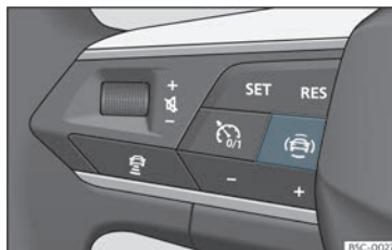
Fig. 62 Multifunktionsrattens vänstra sida: Knapp för förarstödsystem (beroende på version).
