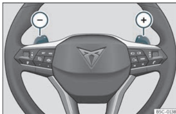
Fig. 143 Ratt: reglage för automatisk växellåda
