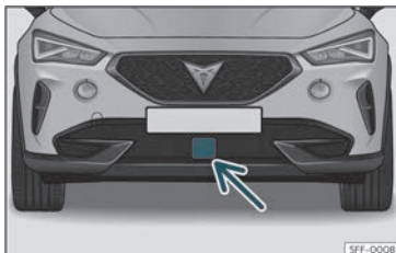
Fig. 145 På den främre stötfångaren: radarsensorer.
