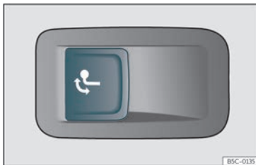
Fig. 185 På bagagerummets vänstra sida: knapp för att låsa upp dragkrok.
