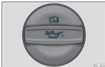
Fig. 204 I motorrummet: Påfyllningslock för motorolja.
