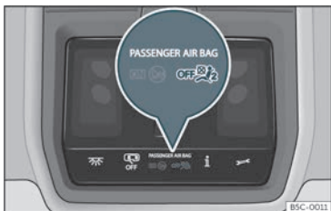
Fig. 16 På takkonsolen: signallampa som visar om krockkudden på passagerarsidan fram är inaktiverad.
