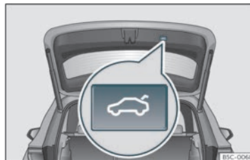
Fig. 82 Baklucka: knapp för att stänga bakluckan.
