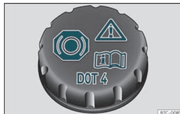
Fig. 208 Motorrum: lock till bromsvätskebehållaren.
