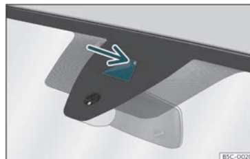
Fig. 147 På vindrutan: synfältet för Lane Assist-systemet.
