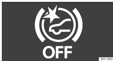
Fig. 155 På instrumentpanelens display: Indikering om att Front Assist är inaktiverat.
