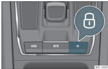
Fig. 75 I mittkonsolen: centrallåsbrytare
