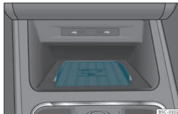
Fig. 135 I mittkonsolen: platta för anslutning av mobiltelefon.
