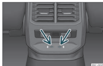
Fig. 137 Bakre delen av mittkonsolen: USB-kontakter med laddningsfunktion.
