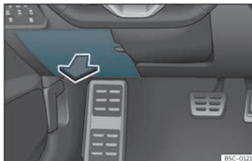
Fig. 47 På instrumentbrädan på förarsidan: säkringsdosans lock.
