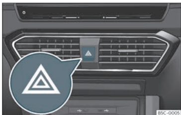
Fig. 91 Instrumentpanel: knapp för varningsblinkers
