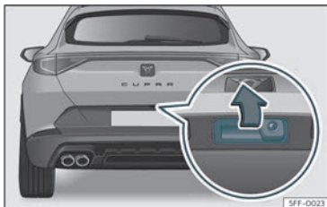
Fig. 81 Baklucka: öppning från utsidan.
