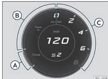
Fig. 57 Digital instrumentpanel: Energimätare (Cupra-vy)
