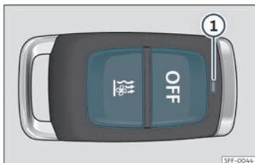
Fig. 129 Parkeringsvärmare: radiostyrd fjärrkontroll.
