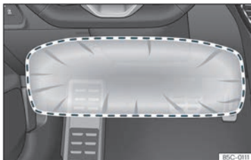
Fig. 18 På förarsidan: krockkuddens utlösningssområde för knäna.
