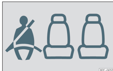
Fig. 5 Instrumentpanel: vänster baksäte används och motsvarande lampa för fastspänt säkerhetsbälte visas på displayen.
