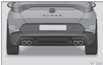
Fig. 148 Vy över bilens bakre del: radarsensorområden.
