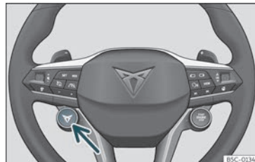
Fig. 144 Multifunktionsratt*: knapp för att ändra körprofil.
