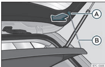
Fig. 109 I bagagerummet: ta bort och montera hyllan.
