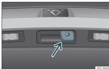
Fig. 150 | Handtaget på bakluckan: placering av backkameran.
