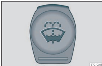
Fig. 209 I motorrummet: lock till spolarvätskebehållaren.
