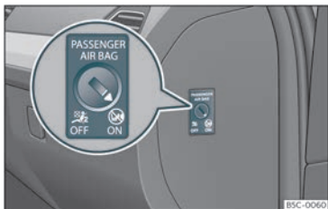
Fig. 15 Brytare för aktivering och inaktivering av passagerarkrockkudden.
