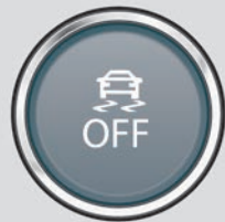
Fig. 174 I den nedre delen av mittkonsolen: knapp för att slå på/av ESC »
