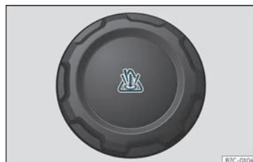
Fig. 207 Motorrum: lock till expansionstanken.
