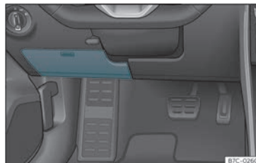
Bild 45 Vänsterstyrd bil: säkringsboxkåpa under instrumentbrädan på förarsidan
