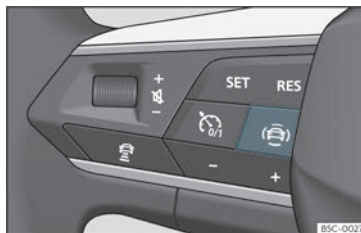
Bild 64 Multifunktionsrattens vänstra sida: knapp för förarstödsystem (beroende på version).
