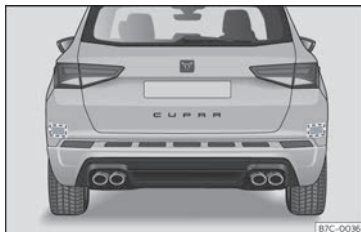
Bild 151 Vy över bilens bakre del: radarsensorområden.
