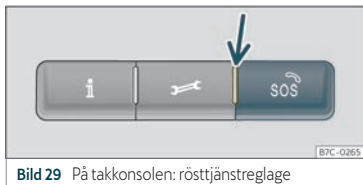
Bild 29 På takkonsolen: rösttjänstreglage
