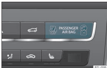
Bild 16 Instrumentpanel: signallampa som visar om krockkudden på passagerarsidan fram är inaktiverad.
