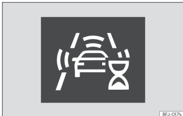
Bild 160 På instrumentpanelens display: indiker- ing om första självkalibrering.
