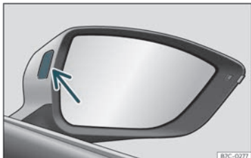
Bild 171 Signallampa för avväkningsvarnare.
