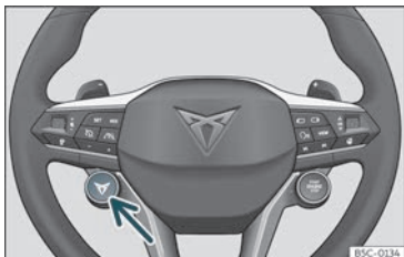
Bild 147 Multifunktionsratt*: knapp för att ändra körprofil.
