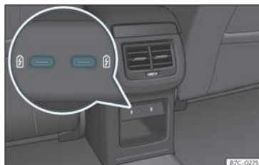
Bild 138 Bakre delen av mittkonsolen: USB-kontakter med laddningsfunktion.
