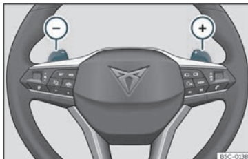
Bild 144 Ratt: reglage för automatisk växellåda
