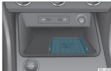
Bild 136 I mittkonsolen: platta för anslutning av mobiltelefon.
