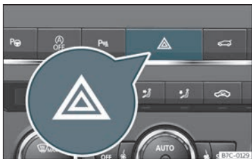
Bild 95 Instrumentpanel: knapp för varningsblinkers
