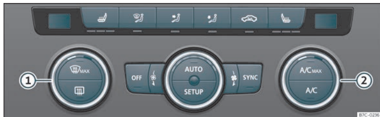
Bild 129 I mittkonsolen: Climatronic-reglage.
