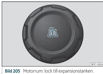
Bild 205 Motorrum: lock till expansionsstanken.
