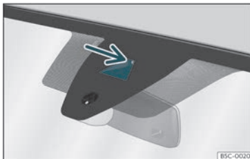
Bild 150 På vindrutan: synfältet för Lane Assist-systemet.
