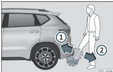
Bild 85 Baklucka med sensorstyrd öppning (Easy Open).
