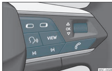
Bild 62 Multifunktionsrattens högra sida: Knappar för att använda kombiinstrumentets menyer och informationsdisplayer (beroende på version).
