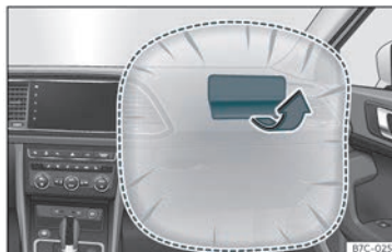
Bild 14 Krockkudde för framsätesspassagerare monterad i instrumentpanelen.
