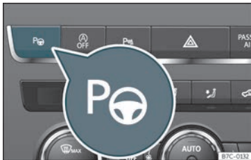
Bild 177 I den övre delen av mittkonsolen: knapp för aktivering av parkeringsassistenten.
