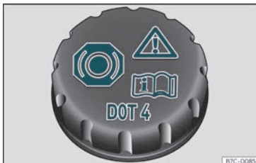
Bild 206 Motorrum: lock till bromsvätskebehållaren.
