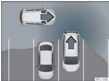
Bild 229 Schematisk representation av assistenten för korsande trafik bakom bilen: övervakat område runt bilen när bilen kör ut ur en parkeringsplats.
