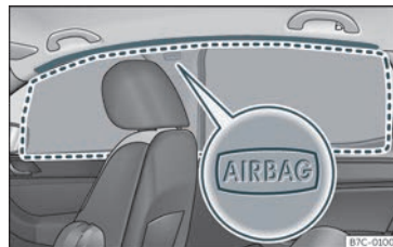
Bild 20 Placering av krockkuddar som skyddar huvudet.
