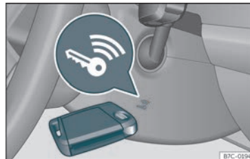
Bild 198 Till höger om rattstängens: nödstart.
