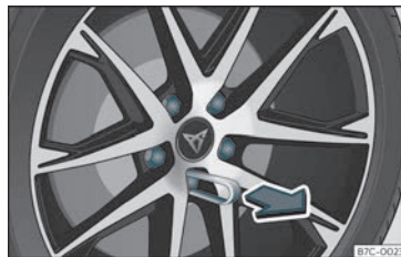
Bild 30 Hjul: hjulbultar med lock.
