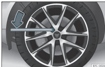
Bild 32 Hjulbyte: lossa hjulbultarna.
