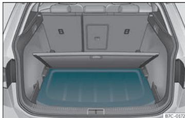
Bild 107 | I bagagerummet: montering av hatthyllan.
