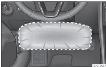
Bild 17 På förarsidan: krockkuddens utlösningssymbol för knäna.
