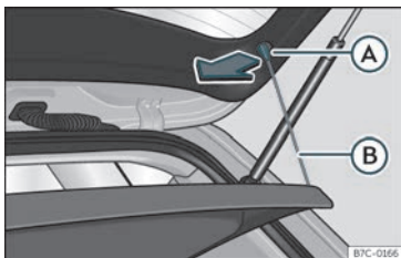
Bild 104 | I bagagerummet: ta bort och montera hyllan.
