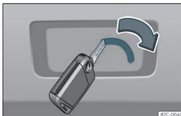
Bild 82 Detaljer kring bagageutrymmet: nödupplåsning
