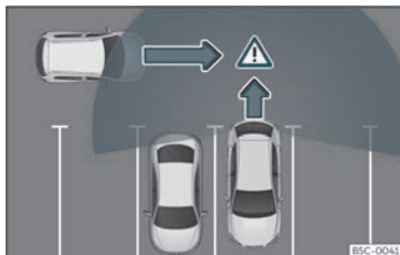
Bild 174 Schematisk framställning av assistenten för korsande trafik bakom bilen: övervakat område runt bilen när bilen kör ut ur en parkeringsplats.
