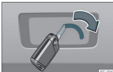
Bild 87 Detaljer kring bagageutrymmet: nödupplåsning
