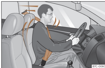
Bild 39 Förare som använder säkerhetsbältet på rätt sätt kastas inte framåt vid en plötslig inbromsning.
