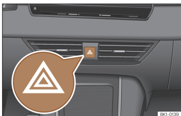
Bild 63 Instrumentbräda: knapp för varningsblinkers.
