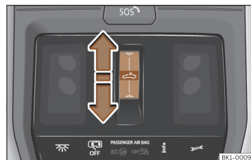
Bild 115 Innertaket: funktionsknappar för solskyddsgardin.
