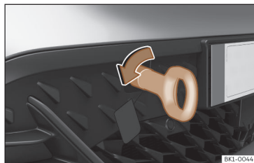
Bild 184 Höger sida på stötfångaren fram: fäste för bogserlina monterat.
