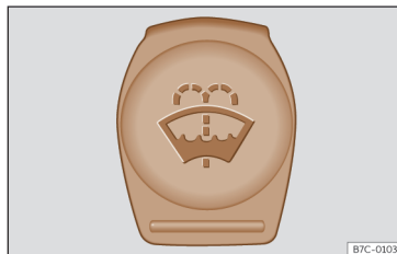
Bild 194 I utrymmet under huven: blått lock till spolarvätskebehållaren.
