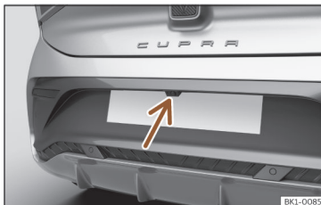
Bild 126 På stötfångaren bak: placering av backassistentens kamera.
