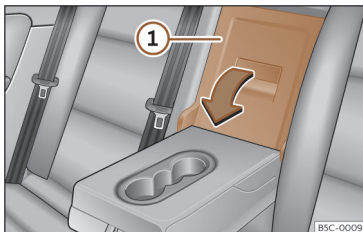
Bild 175 På baksätets ryggstöd: öppna genomlastningsluckan.
