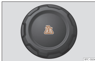
Bild 192 Utrymmet under huven: lock till expansionskärlet för kylvätska.
