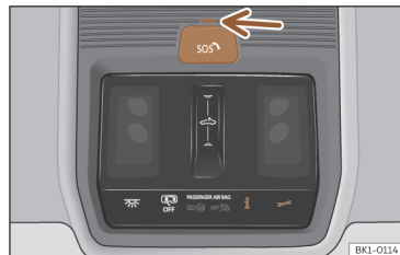
Bild 64 På takkonsolen: reglage för rösttjänster.
