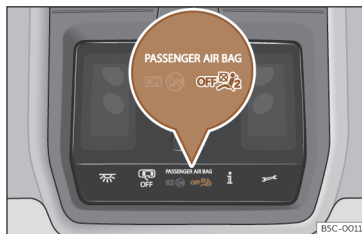
Bild 49 På takkonsolen: signallampa för avaktivering av passagerarkrockkudden.
