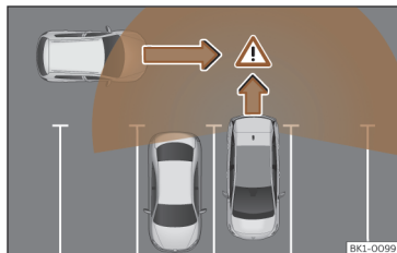
Bild 144 Schema över parkeringsassistenten: detekteringsområde runt bilen som kör iväg.
