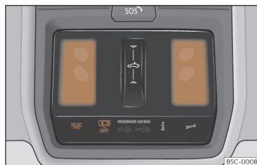
Bild 108 Detaljer i taket: Framre innerbelysning.
