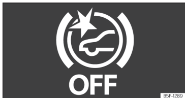
Bild 135 Meddelande om att Front Assist är avaktiverat på instrumentpanelens skärm.
