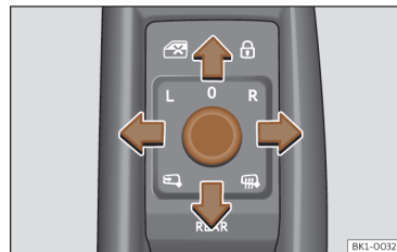
Bild 113 Detaljbild på förardörren: Reglage för ytterbackspegel
