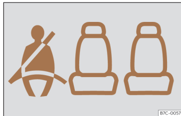
Bild 38 Kombiinstrument: statusindikation för säkerhetsbältena i baksätet.
